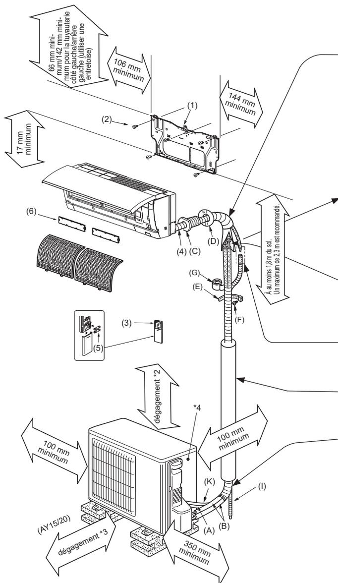
Veillez à utiliser le manchon d'ouverture murale (C) pour éviter tout contact entre le câble de connexion de l'unité interne/externe (A) et les pièces métalliques du mur ou toute détérioration causée par les rongeurs si le mur est creux.
