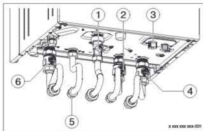
Fig. 11 Raccords côté gaz et eau xDOS GA 18
