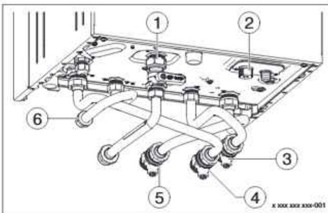
Fig. 7 Raccordements côté gaz et eau xDOS GA 6
