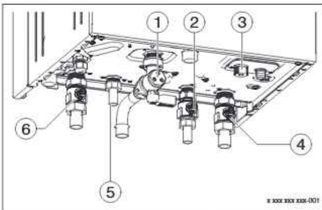
Fig. 6 Raccordements côté gaz et eau xDOS GA 5/xDOS GA 15
