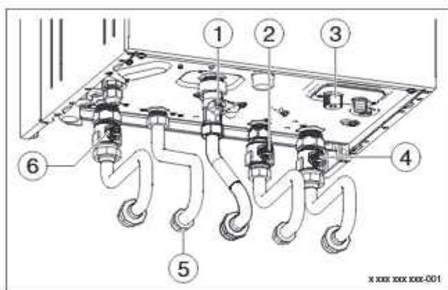
Fig. 10 Raccords côté gaz et eau xDOS GA 16
