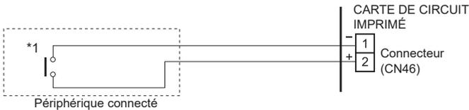
\*1 : Le commutateur peut être utilisé avec les conditions suivantes : De 12 Vcc à 24 Vcc, de 1 mA à 15 mA.
