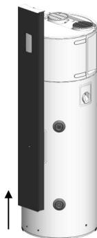
❷ Soulever la colonne pour la décrocher des inserts en bas en faisant attention au câble de l'écran commande et au câble de terre.
