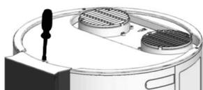
❶ Retirer la vis de verrouillage de la colonne.
