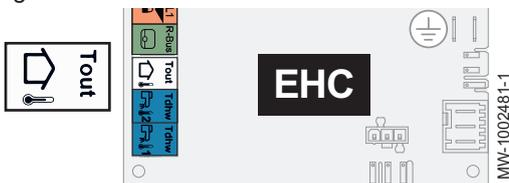
**6.6.8 Raccorder un dispositif de chauffage d'appoint**
