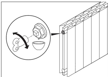
6. Purgez tous les radiateurs au niveau du raccord prévu à cet effet (en haut du radiateur, à gauche ou à droite).
