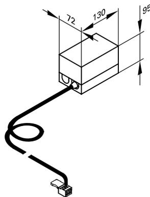
L'aquastat de surveillance est à monter sur le départ chauffage et arrête le circulateur chauffage si la température de départ est excessive.
