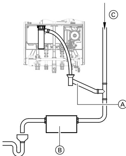
Les Vitodens pourront (si nécessaire) être livrées avec un équipement de neutralisation des condensats indépendant (accessoire). Les condensats formés seront dirigés vers l'équipement de neutralisation et traités.
