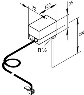
L'aquastat de surveillance est à implanter dans le départ chauffage et arrête le circulateur chauffage si la température de départ est excessive.
