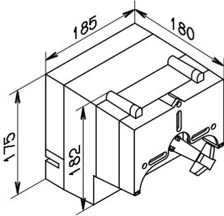
La régulation de vanne mélangeuse sera montée directement sur la vanne mélangeuse Viessmann DN 20 à 50 et R 1/2 à R 1 1/4.
