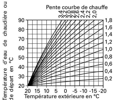
La température d'eau de chaudière est limitée vers le haut par l'aquastat de surveillance et la consigne de température réglée sur la régulation électronique de température maximale. La température de départ ne peut pas dépasser la température d'eau de chaudière.
