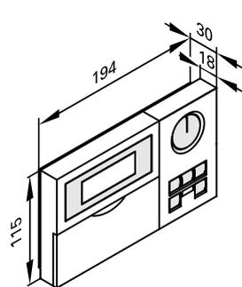
La commande à distance Vitotrol 300 permet, pour un circuit de chauffage, de régler la température ambiante désirée en marche normale et réduite, de sélectionner le programme de fonctionnement et de régler la programmation du chauffage, de la production d'eau chaude sanitaire et de la pompe de bouclage eau chaude sanitaire.
