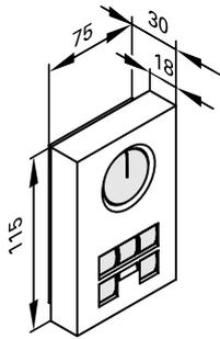
La commande à distance Vitotrol 200 permet, pour un circuit de chauffage, de régler la température ambiante désirée en marche normale et de sélectionner le programme de fonctionnement depuis une pièce au choix.
